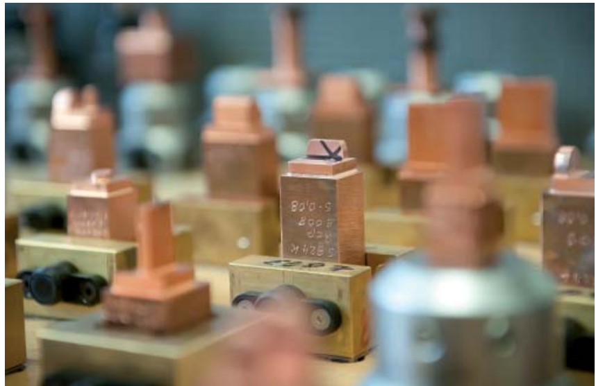
Bild 1: Dank der Werkstattsteuerungssoftware können auch Ersatzelektroden aus Kupfer schnell angefertigt werden.
